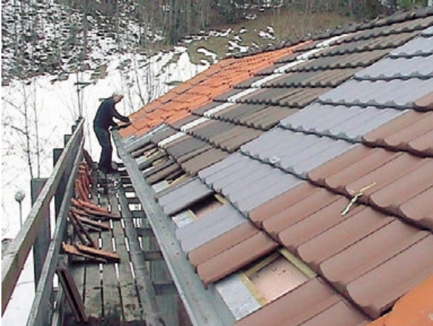
Eindecken und Prüfen der Dachziegel auf der Versuchsstation Cladding and testing of the clay roofing tiles on the test station
